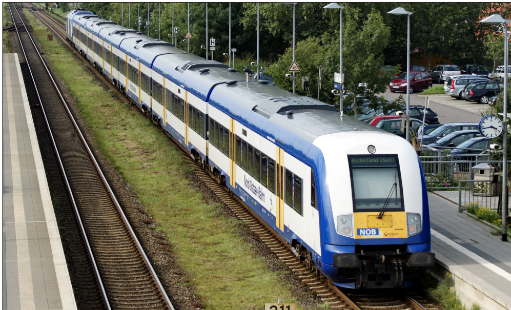
Auf dieser Aufnahme, die Matthias Maier am 25. August 2011 in Klaxnbüll anfertigte, erkennt man, dass die Klimageräte zum Nachbarwagen immer um 180° gedreht sind.
