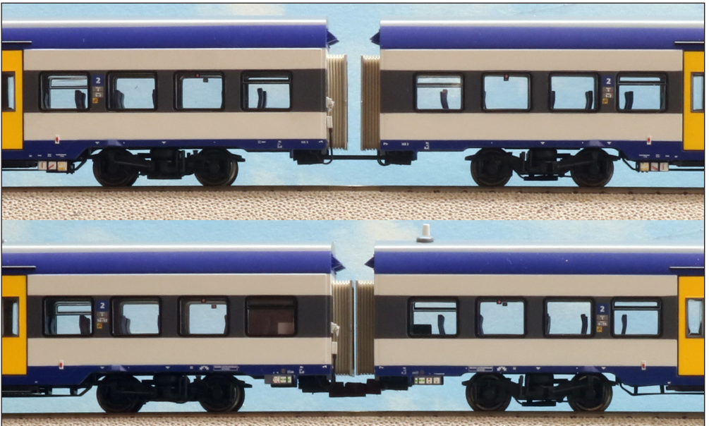
Hier noch einmal der Vergleich: oben der Kuppelabstand bei Nutzung der kürzeren der beiden mitgelieferten Kuppelstangen, unten der Abstand mit der selbst entworfenen, trennbaren Kupplung. Fotos (2): Michael Mrugalla
