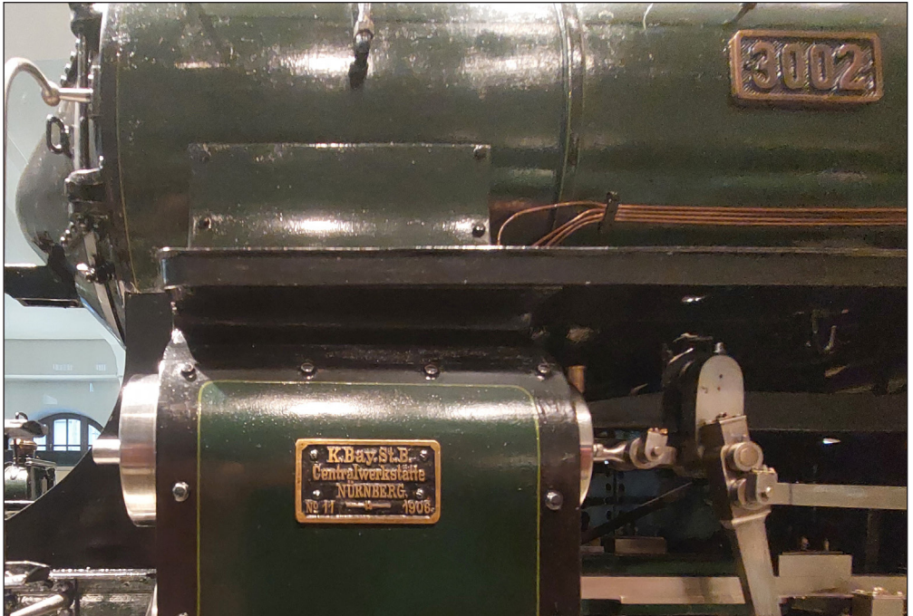
Auf dieser Detailaufnahme sieht man das Fabrikschild der S2/5. Es verrät uns, dass die Lok im Jahr 1906 mit der Fabriknummer 11 von der K.Bay.St-B. Centralwerkstätte Nürnberg gebaut wurde. DB Museum/Foto: Ebenfeld
